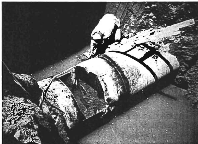
Foto 1.1 Daño en tubería de acero debido a propagación de ondas. Ciudad de México (1985)
