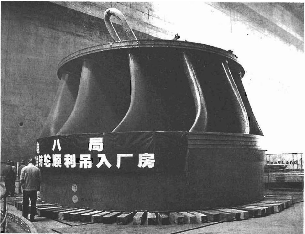
Sanxia Runner (Cortesía de Voith Siemens Hydro Power Generation)
