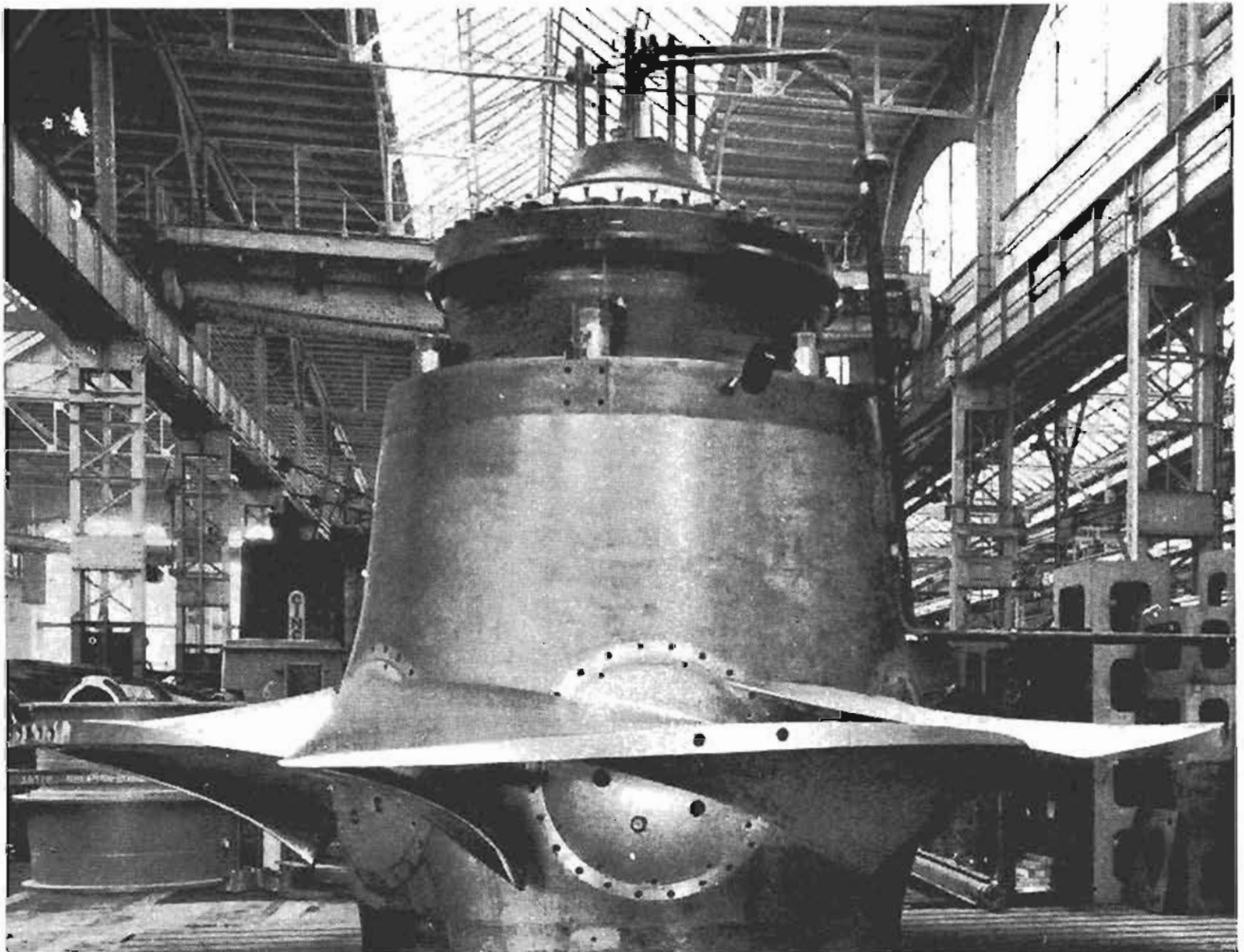
16 Figura 7.7. Rodete Kaplan (posición cerrado) (Cortesía Escher Wyss)
