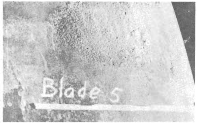
Figura 12.4. Nótese el desgaste por cavitación en el asa de una turbina Kaplan (Cortesía Allis Chalmers)
