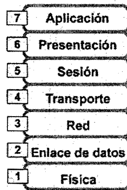
Figura 4.1. Las 7 capas del modelo OSI.
