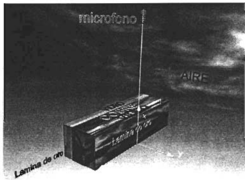
Dibujo 8. Configuración 3. Se muestra la posición de las dos láminas de oro, el cobre y el vidrio, además del micrófono y la orientación de los ejes.
