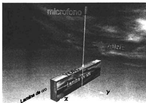
Dibujo 6. Configuración para la medición a . Se muestra la posición de las dos láminas de oro y el vidrio, además del micrófono y la orientación de los ejes.
