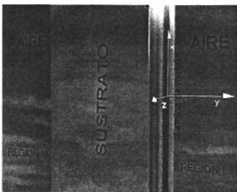
Dibujo 1. Diagrama que muestra la Configuración 1. Ésta comprende 3 regiones sobre el eje Y, en la región 1 y 3 hay aire y en medio hay un sustrato de largo y ancho infinito y grosor d. Adherida a la cara del sustrato de la región 1, se encuentra una lámina de metal con grosor despreciable
