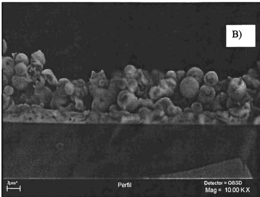
Figura 38. Microfotografías de perfil para la película de circonia preparada a 500^\circ\text{C} a diferentes magnificaciones. A) 2500\text{ X} y B) 10000\text{ X} .
