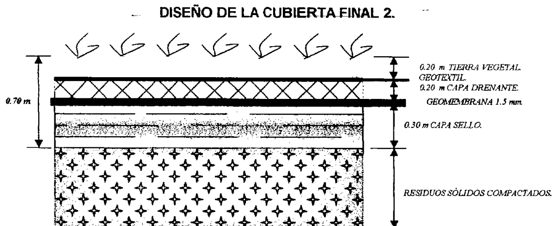
Figura No. 5.4. Alternativa No. 2 de Material de Sello para la Cubierta Final.
