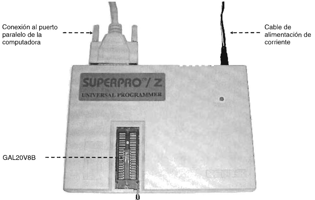
**Fig. 2.36. Montamos la GAL20V8B sobre el grabador de memorias SUPERPRO/Z y seleccionamos en el software la opción de programar**
