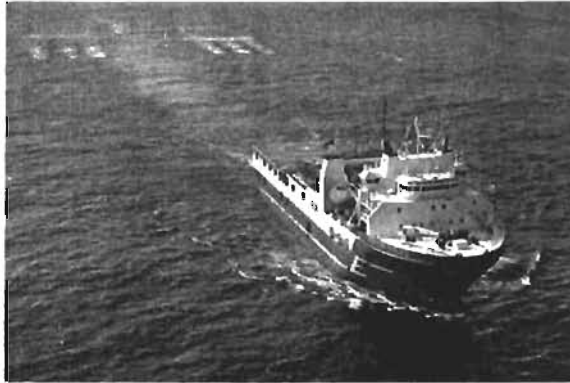
Figura 1.12A Barco equipado para realizar estudios sísmicos. A fondo de la imagen se pueden ver los geófonos utilizados para recibir información útil para los ingenieros geofísicos.
