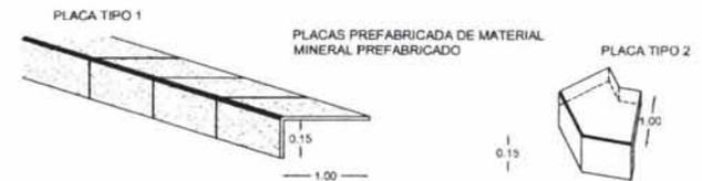
PIEZA ESPECIAL DE ACOPLAMIENTO SEGUN DISEÑO
