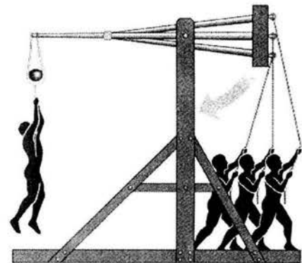
Fig 0-2 Trabuco de tracción operado por varios hombres. Cuando el hombre de la izquierda se suelta el brazo impulsa al proyectil.
