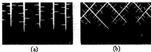
FIGURA 2.3. El PSi está conformado por alambres nanométricos de c -Si entrelazados cuya forma se asemeja a la de un coral marino.
