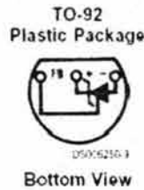
Figura 1.14 El LM385 variable para suministrar pequeños voltajes de referencia
