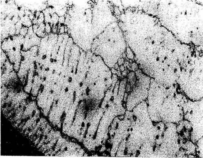
Fotografía 3. Se observa una estructura equiaxial de Ferrita con escasa Austenita retenida inter cristalina y transcristalina , escasos Carburos inter cristalinos y transcristalinos, con pequeños cristales de Perlita. 600X.
