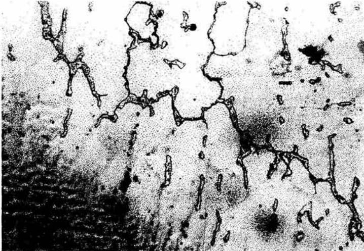
Fotografía 13. Se observa el crecimiento de la Austenita retenida, el aumento de la cantidad de Carburos los cuales coalescen y migran al borde de grano. Se observa la estructura equiaxial de Ferrita y pequeños cristales de Perlita. 600X.
