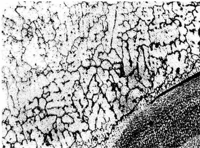
Fotografía 21. Se observa una estructura de Ferrita equiaxial cerca de la línea de fusión con precipitación inter cristalina y transcristalina. Se observa la reducción de la Austenita retenida y el aumento en la cantidad de Carburos que coalescen y migran al borde de grano.50X.
