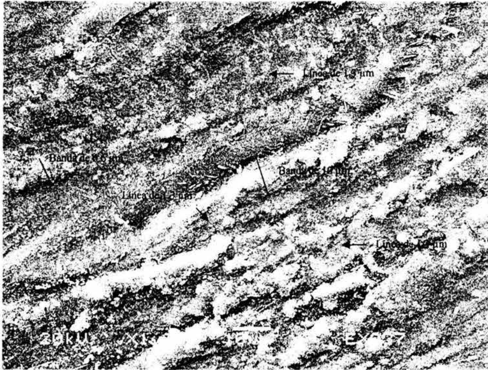
Fig. 84: huellas producidas por el corte de la espira con polvo de obsidiana, a 1000X. Se observa una superficie rugosa, resultado de la presencia de líneas rectas del orden de las 1.3 µm de ancho, que se aglomeran dando lugar a bandas irregulares de tamaños variables.
