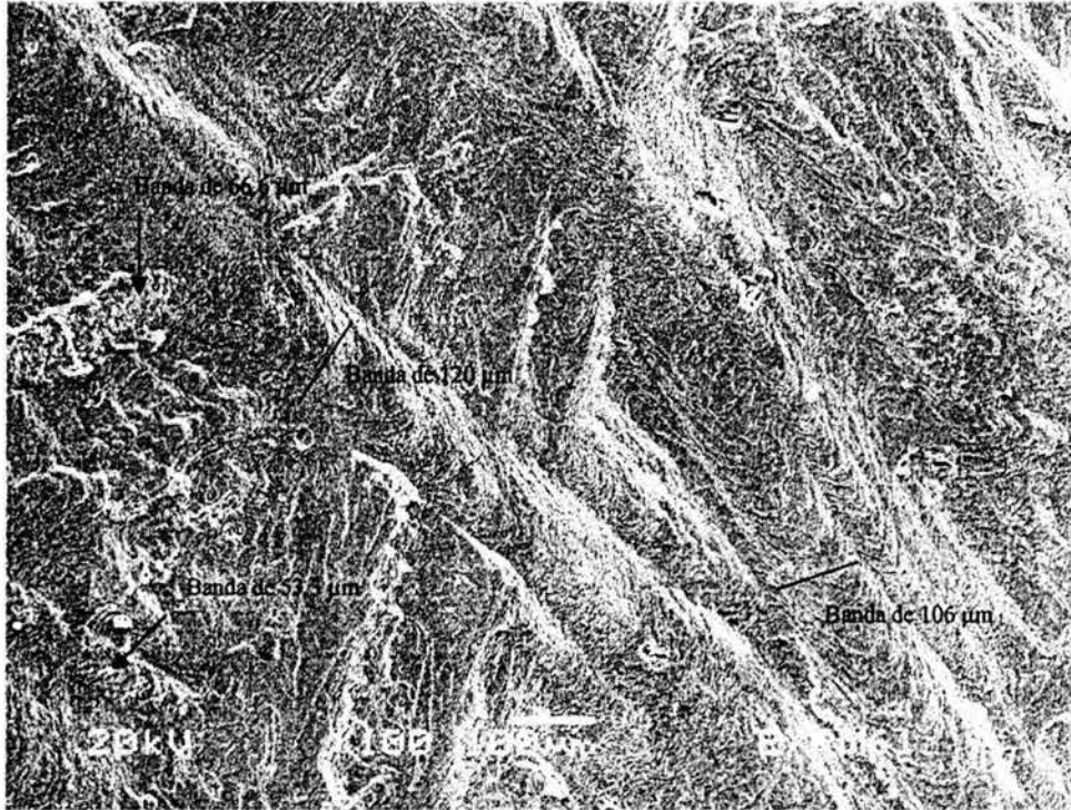
Fig. 17: Huellas producidas por el desgaste superficial de valvas de Pinetada mazatlanica con riolita (a) y granito (b) a 100X. En el primer caso se observan bandas planas entrecruzadas de entre 20 y 26 \mu\text{m} de espesor, que eventualmente se juntan para formar aglomerados; en el segundo se aprecian bandas redondeadas de con dos órdenes de grosores: entre 50 y 60 \mu\text{m} , y entre 100 y 120 \mu\text{m} .
