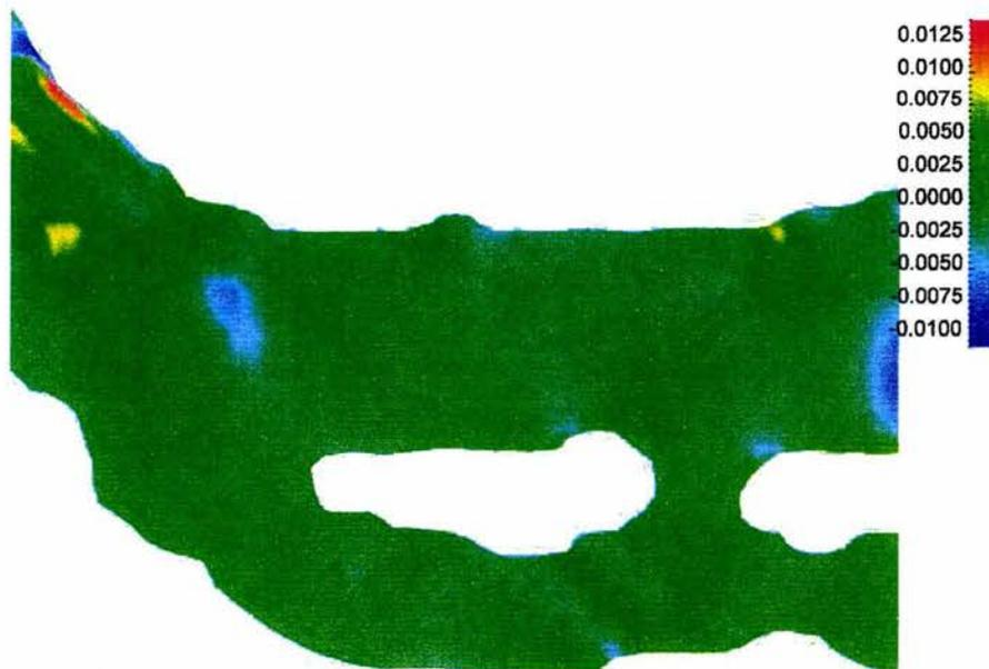
Figura 5.11: Erosión producida con la cuarta simulación, en metros, los valores positivos indican depósito y los negativos erosión
