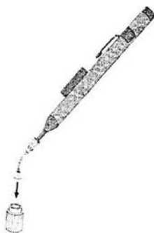
Figura 4. Instalación de la membrana de seguridad
