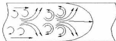
Figura 1.14 Perfil de un flujo turbulento en un fluido No Newtoniano.
