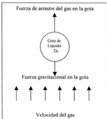
Figura 1-1 Fuerzas que actúan en una gota de líquido en una corriente de gas.
