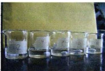
Fig. 3.6 Se colocan las soluciones buffer 2, 4, 7, 10 y 13 en vasos de precipitados de 50 ml.
