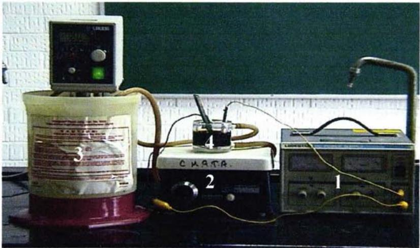
Fig. 3.1 Proceso de electropulido:
