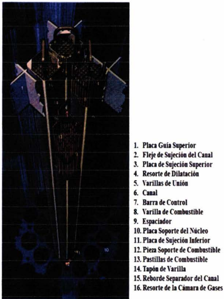
Figura 2.6. Isométrico de un ensamble de combustible y módulo de la barra de control. (BWR, GE Nuclear Energy)
