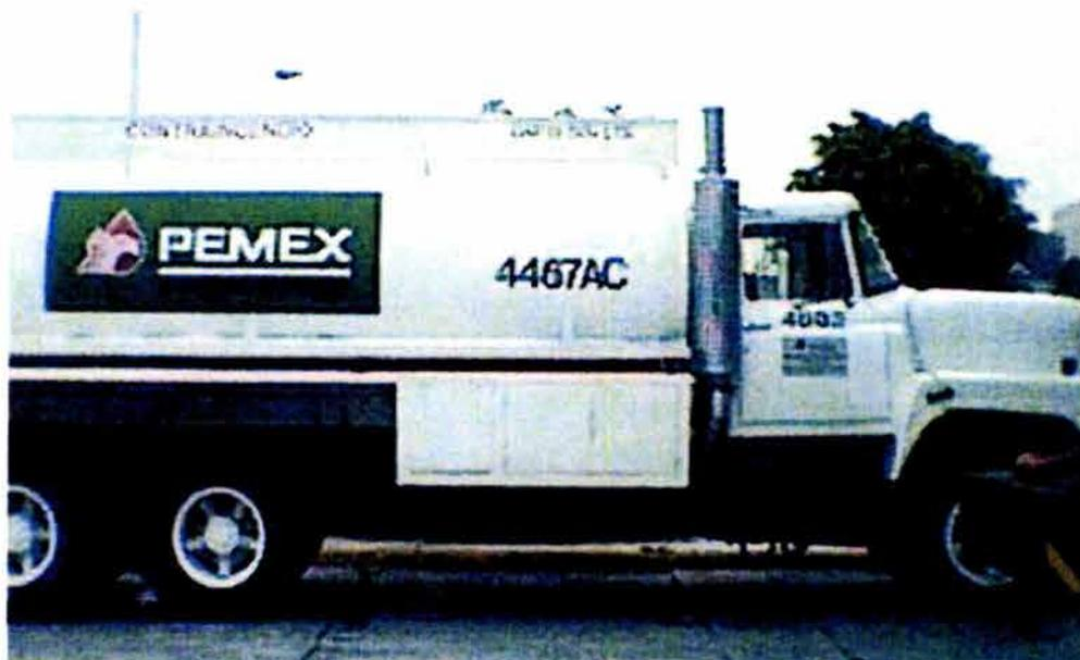
**Imagen de un autotanque de 20,000 lts de capacidad utilizado para transportar producto**
