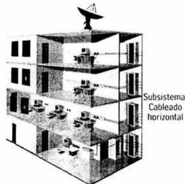
**Figura 2.15 Subsistema de Cableado Horizontal**
