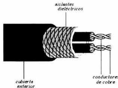
Figura 2.4 Cable de par trenzado (dos pares STP).
