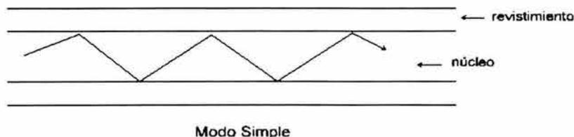
**Figura 2.8 Fibra óptica monomodo simple**
