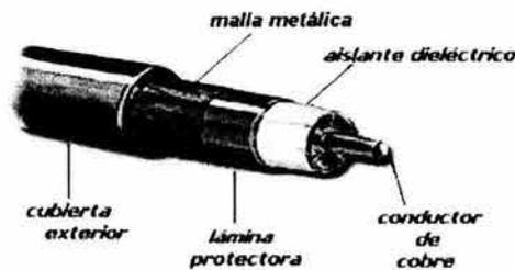
Fig. 2.1 Componentes de un cable coaxial.
