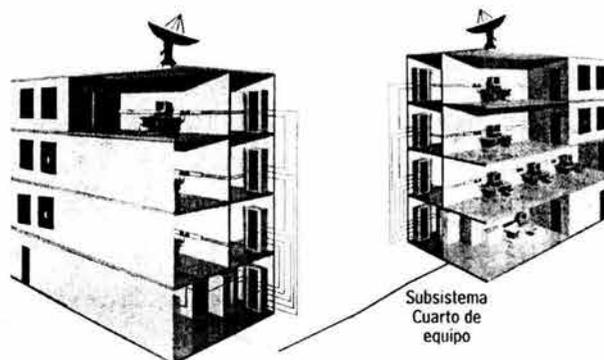
**Figura 2.14 Subsistema Cuarto de Equipo**
