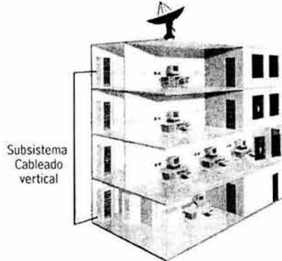
**Figura 2.17 Subsistema de Cableado Vertical**
