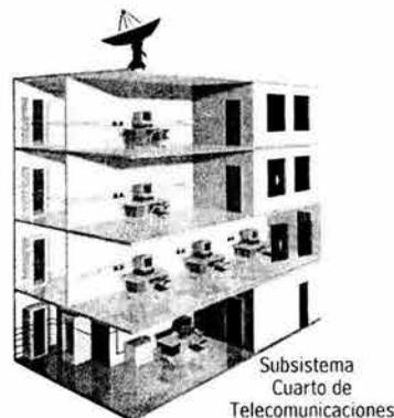
**Figura 2.16 Subsistema de Cuarto de Telecomunicaciones**
