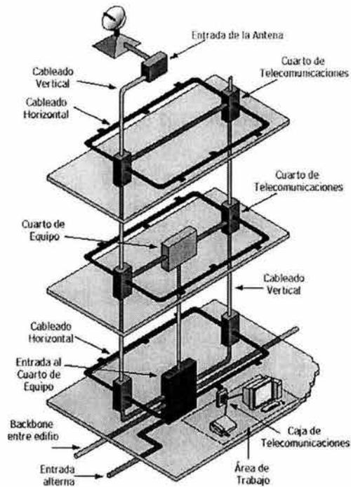
**Figura 2.19 Subsistema del estándar EIA/TIA 569 de Cableado Estructurado**
