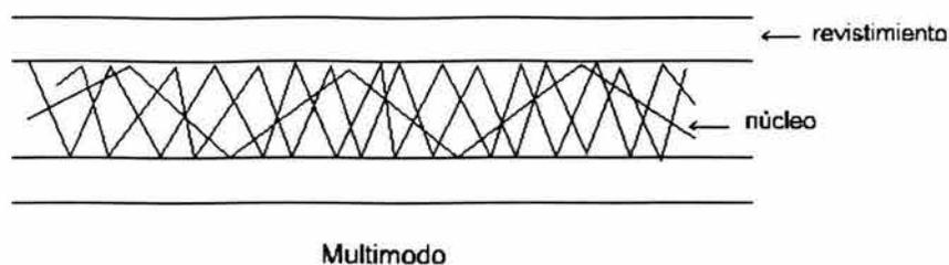
**Figura 2.9 Fibra óptica multimodo**
