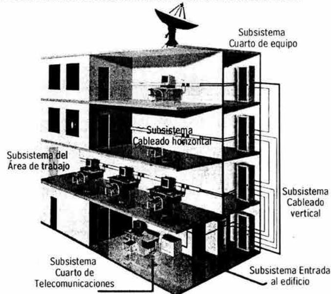
**Figura 2.12 Subsistemas de un Sistema de Cableado Estructurado**
