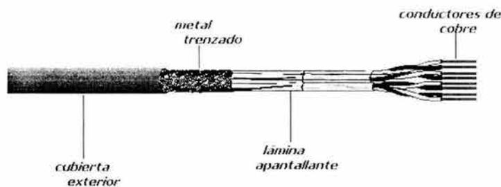
**Figura 2.6 Cable SPT de cuatro pares.**
