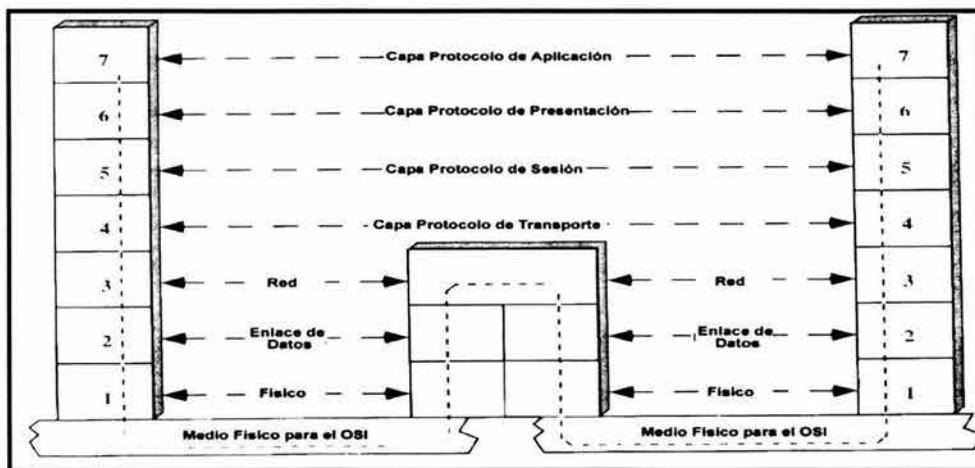
Figura 1.2 Interacción del medio físico y el modelo OSI
