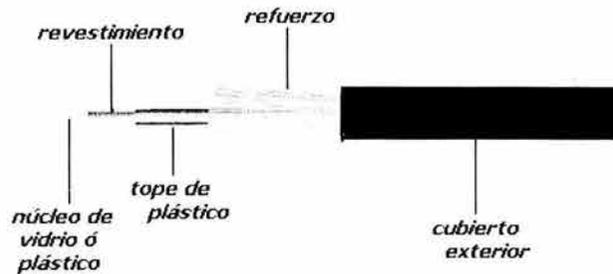
**Figura 2.7 Partes de una fibra óptica.**
