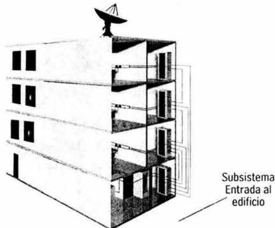
**Figura 2.13 Subsistema de Entrada al Edificio**
