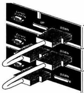
**Figura 5.1** Cables para apilamiento de hubs.
