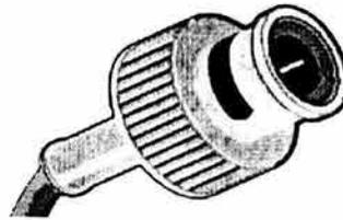
Figura 2.3 Cable Coaxial Thin (fino).
