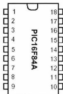
Figura 2.38 Diagrama del PIC16F84A con la numeración de patitas
