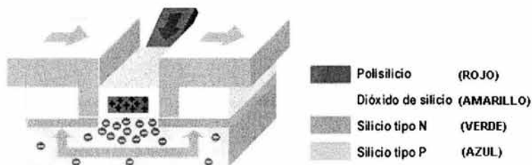
Figura 2.37 Imagen del funcionamiento de un transistor
