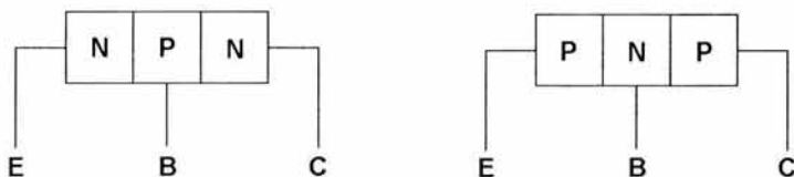
Figura 2.43 Estructuras de transistores NPN y PNP
