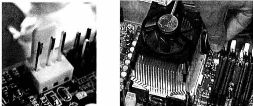
Figura 3.25 Toma de corriente para el ventilador y disipador con ventilador
