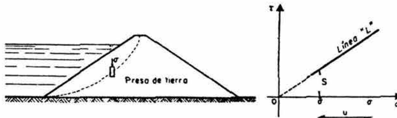
Fig. 5.5 Obtención de la resistencia al esfuerzo cortante del suelo, trabajando con esfuerzos efectivos (Juárez y Rico, 1997)
