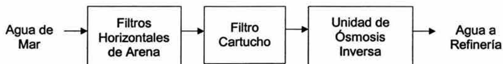
Figura 4.10 Tren de desmineralización de agua de mar.
