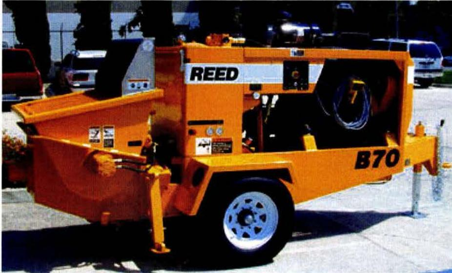
*Figura II.11 Lanzadora para mezcla húmeda*
