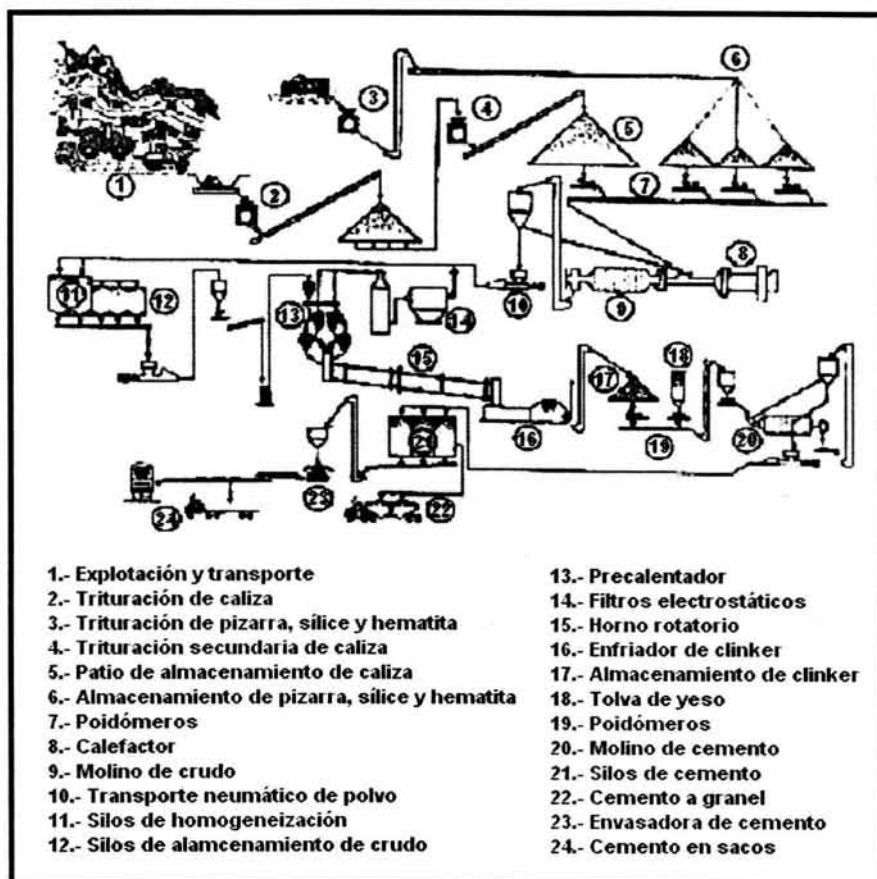
FIGURA III.1 PROCESO DE FABRICACIÓN DEL CEMENTO
