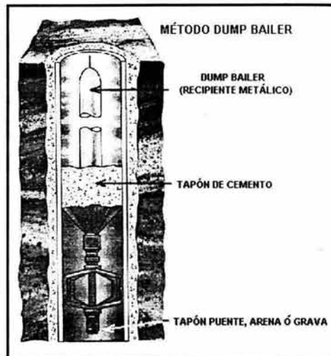
FIGURA VI.6 MÉTODO DE DUMP BAILER
