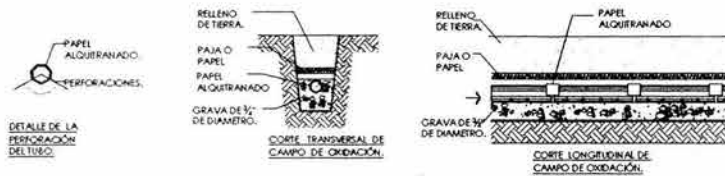
DETALLE ( 9 ) . CAMPO DE OXIDACIÓN.
