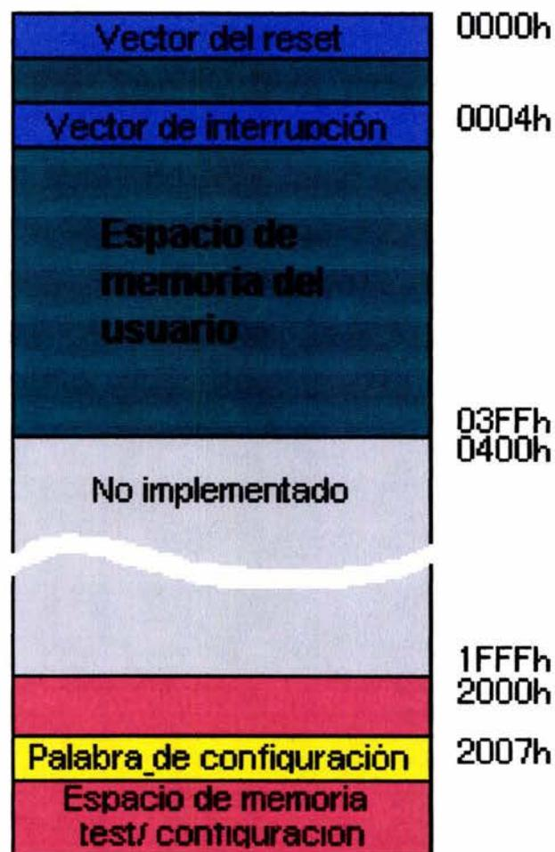
Fig. 3.4 REGISTROS DE CONFIGURACIÓN DEL PIC16F84
