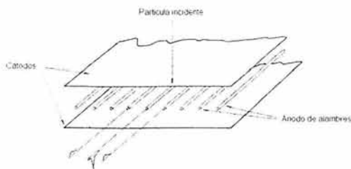
Figura 10. Arquitectura básica de un detector multialámbrico.
