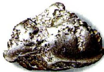
El platino puede obtenerse en forma esponjosa por descomposición térmica del cloroplatinato de amonio o al reducirlo de una solución acuosa. En esta forma muestra un alto poder de adsorción, respecto de los gases, en especial oxígeno, hidrógeno y monóxido de carbono. La alta actividad catalítica del platino está relacionada directamente con esta propiedad. El platino posee una fuerte tendencia a formar compuestos de coordinación.
