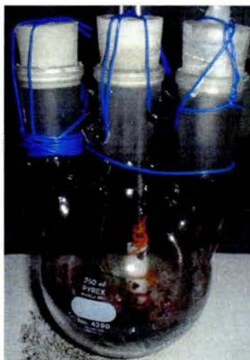
Figura 8. Precipitado de color morado, después de purgar CO en la solución de  $\text{H}_2\text{PtCl}_6$
