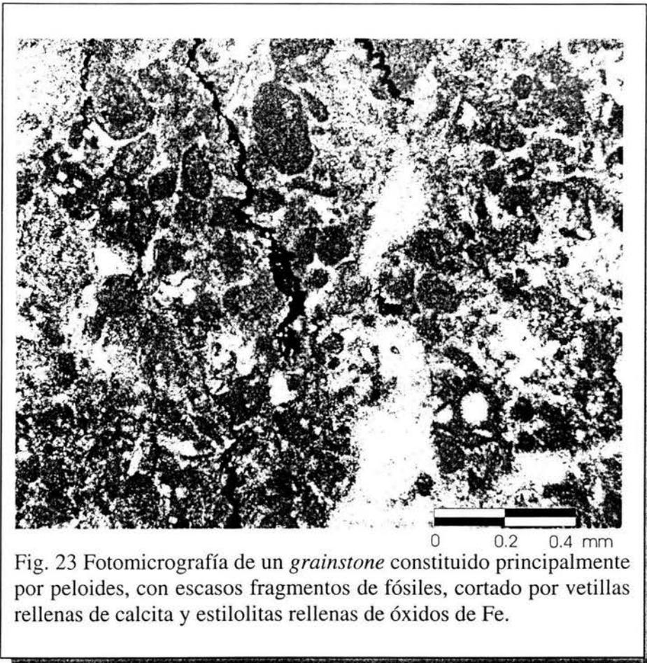
Fig. 23 Fotomicrografía de un *grainstone* constituido principalmente por peloides, con escasos fragmentos de fósiles, cortado por vetillas rellenas de calcita y estilolitas rellenas de óxidos de Fe.
