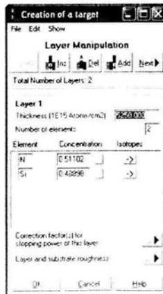
Figura 3.2 Ventana del programa SIMNRA en la cual se introducen los datos referentes a las capas componentes de la muestra a simular.
