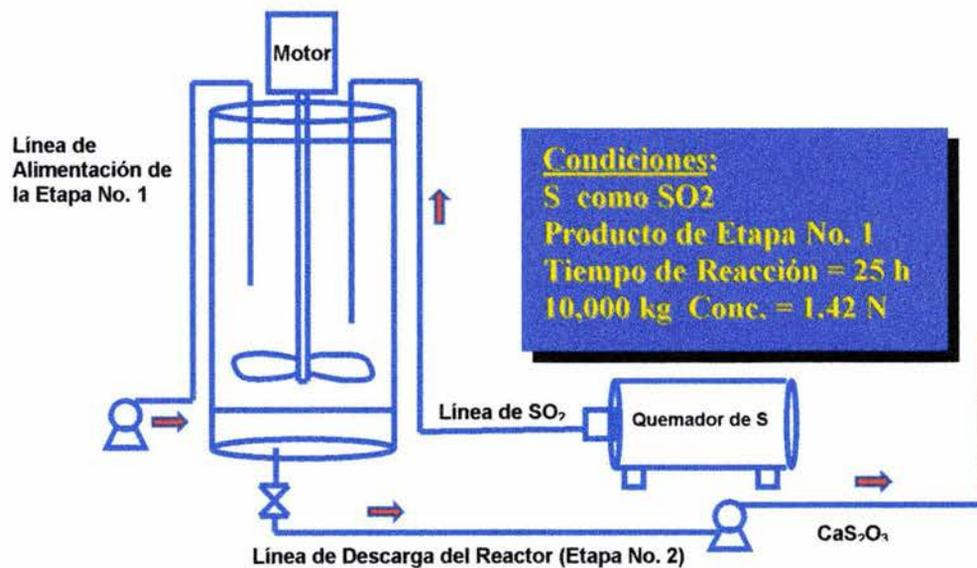
Figura III.4 Diagrama de flujo de la segunda etapa de la preparación de  $\text{CaS}_2\text{O}_3$
