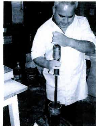
Foto 1.5 Compactación Proctor estándar
