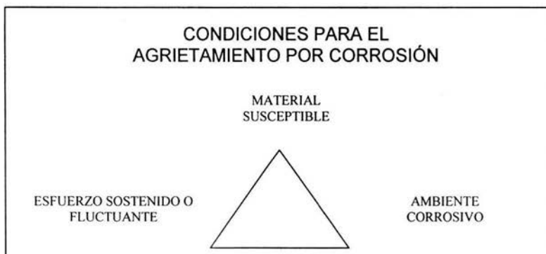
Figura No. 8 Condiciones de agrietamiento por corrosión.
