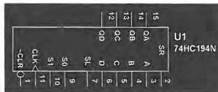
Figura III.1 Diagrama de un Registro de Corrimiento
