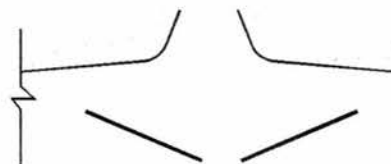
c) Espigones separados e inclinados a la línea de costa
