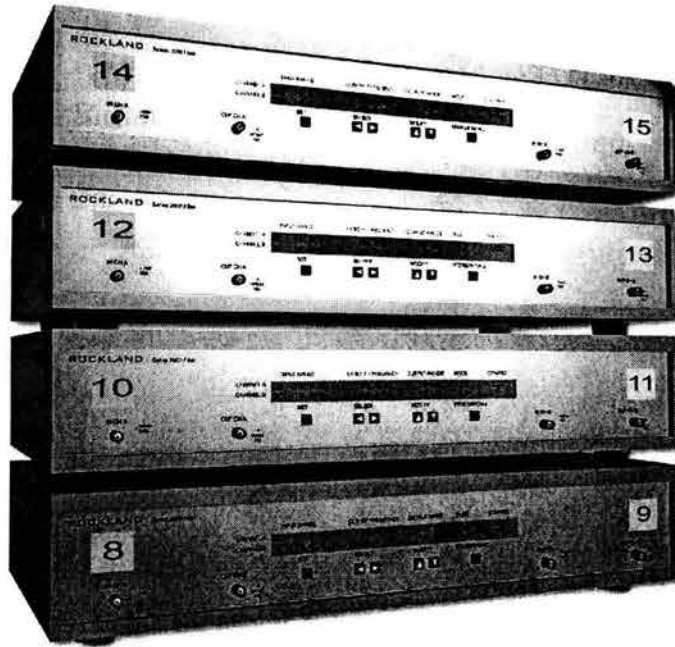
Fig 4.3 Acondicionadores de señal
