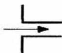
Figura 2.43 Entrada de Borda, accesorio u orificio por donde entra o fluye un fluido.
