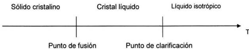
Figura 2. Diagrama de fases de los CL en función de la temperatura
