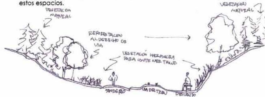
La utilización de vegetación en zonas donde existan cortes de terreno o taludes beneficiará para contener y consolidar el terreno, además de proporcionar espacios con vegetación.
