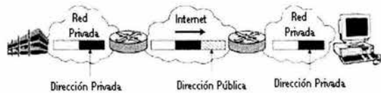
Figura 5.2 Dirección IP privada enmascarada vía tunneling
