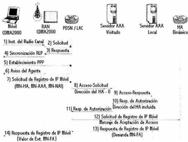
Figura 7.16 Establecimiento de la asignación de un HA dinámico
