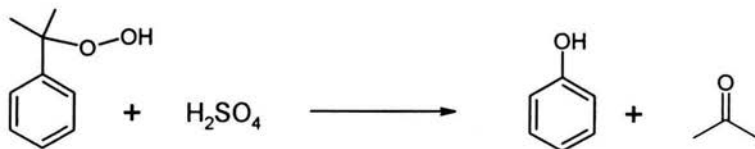
Fig. 6.7 Ruta del cumeno para la obtención de fenol.
