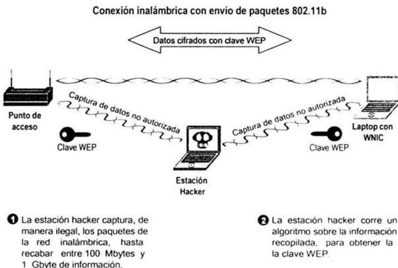
Figura 7-3. Ataque a una red LAN inalámbrica
