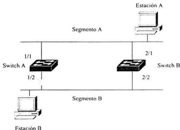
Figura 4-6. Eliminación de enlaces redundantes
