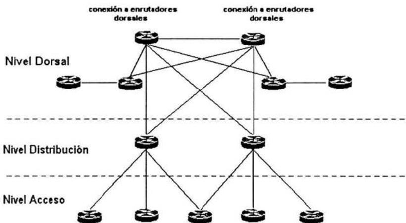
Figura 2-1. Esquema de una red jerárquica
