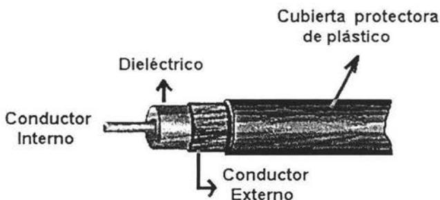
Figura 2-14. Estructura del cable coaxial.
