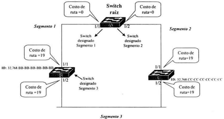
Figura 4-7. Elección del switch designado por segmento
