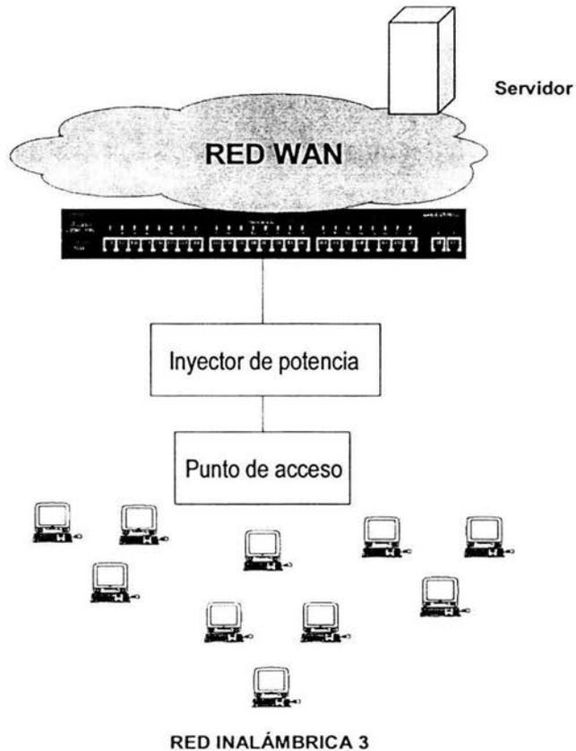
Figura 7-9. Infraestructura de una red LAN inalámbrica del proveedor 3
