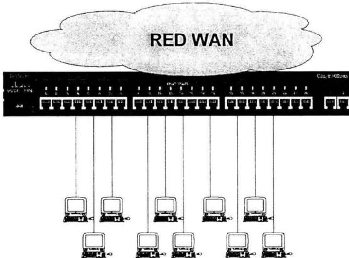
Figura 7-6. Diagrama de una red LAN alámbrica
