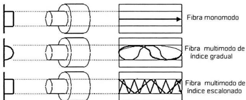
Figura 2-17. Clasificación de la fibra óptica.
