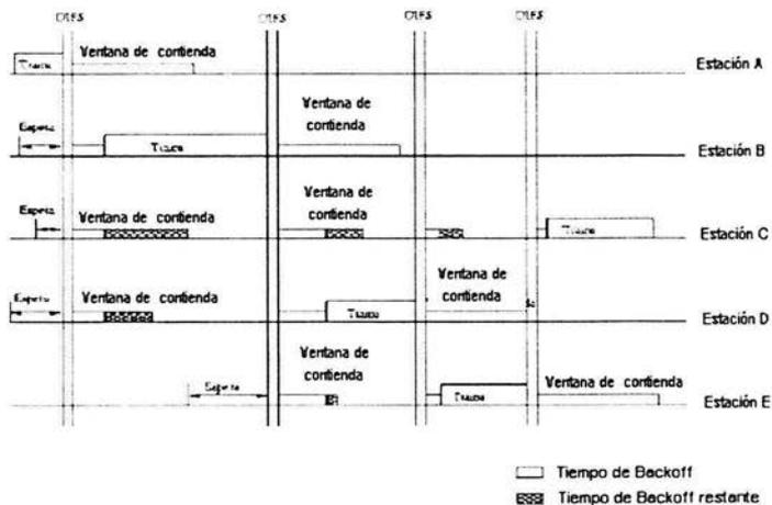
Figura 5-14. Funcionamiento del CSMA/CA.
