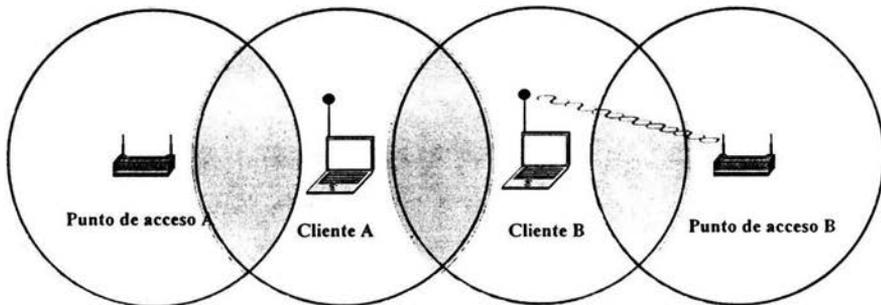
Figura 5-16. Diagrama de nodo expuesto
