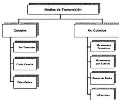
Figura 2-13. Clasificación de los medios de transmisión
