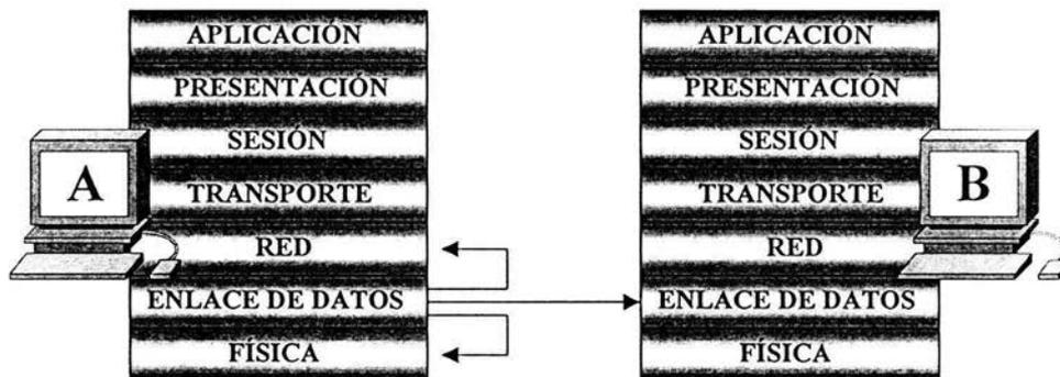
Figura 2-7. Interacción de las capas del modelo OSI.
