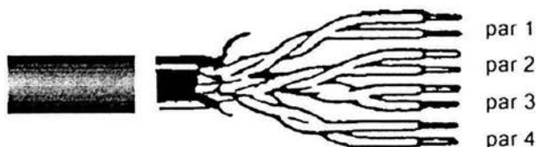
Figura 2-15. Estructura del cable multipar
