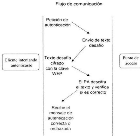
Figura 5-19. Diagrama de autenticación *Shared Key*
