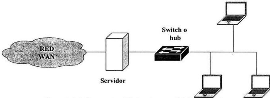
Figura 7-1. Infraestructura básica de una red LAN alámbrica
