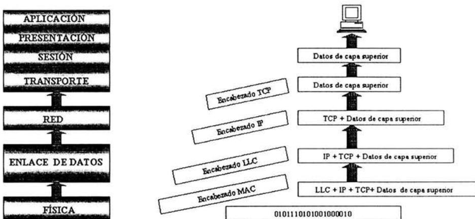
Figura 2-12. Proceso de Desencapsulación
