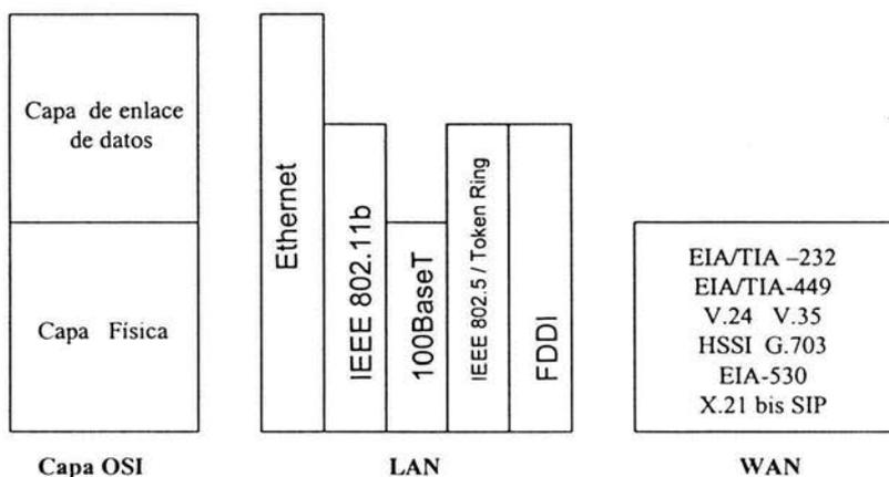
Figura 2-4. Especificaciones de la capa física
