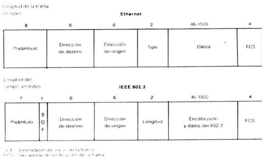
Figura 3-4. Formatos de las tramas IEEE 802.3 y Ethernet
