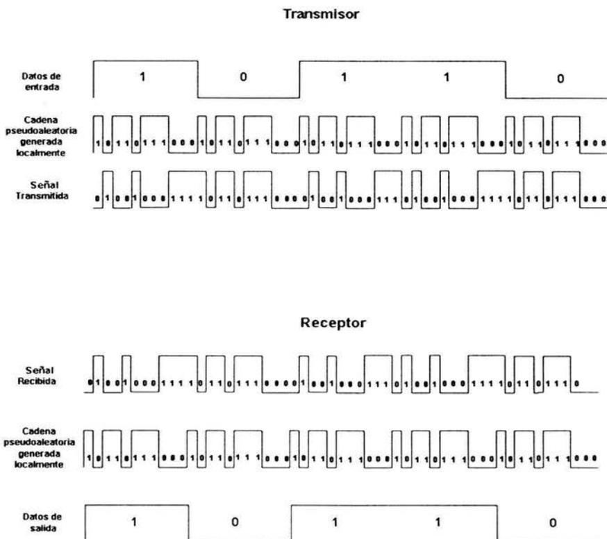
Figura 5-4. Procesamiento de la señal con DSSS
