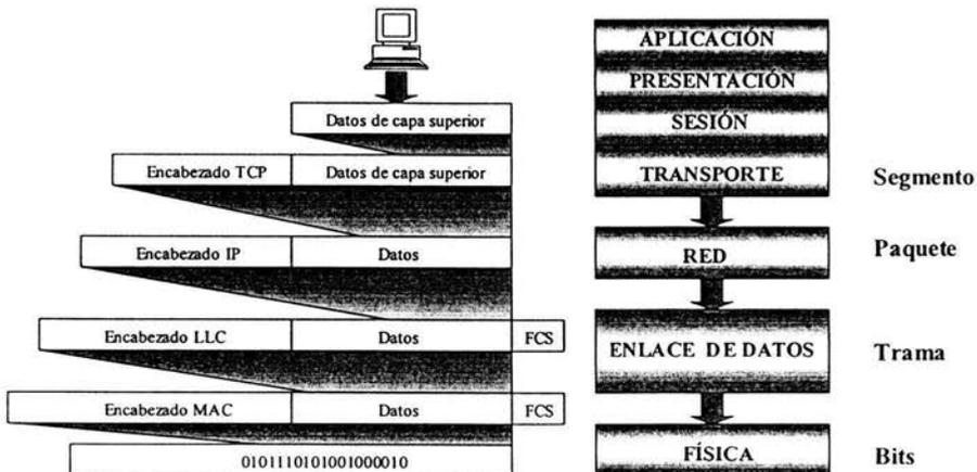
Figura 2-11. Encapsulación de datos
