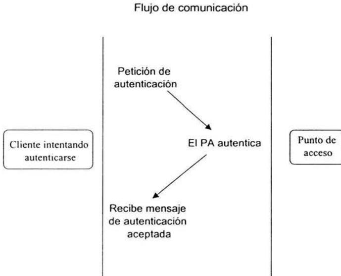
Figura 5-18. Diagrama de autenticación abierta
