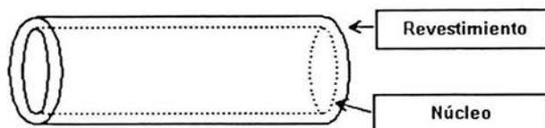
Figura 2-16. Estructura de la fibra óptica
