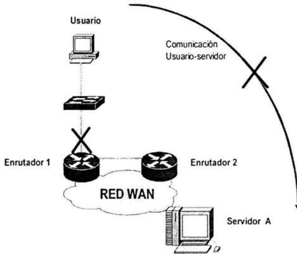
Figura 4-3. Enlace no redundante
