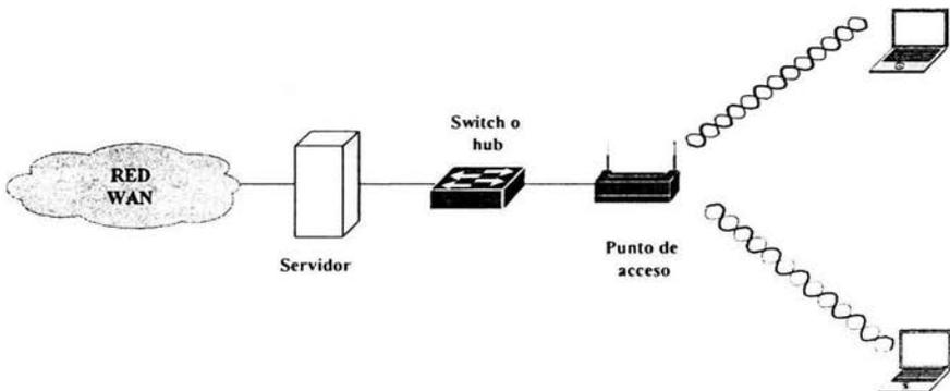
Figura 7-2. Infraestructura básica de una red LAN inalámbrica.
