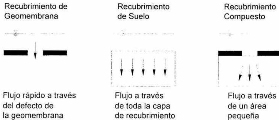
Fig. III.5 Patrones de flujo de a través de recubrimientos de geomembrana, suelo y compuestos (Fuente: Daniel, 1993).
