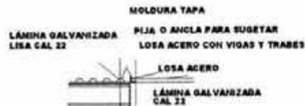
DETALLE DE ARMADO DE TABLEROS DE LOSA ACERO EN EDIFICIO DE OFICINAS
