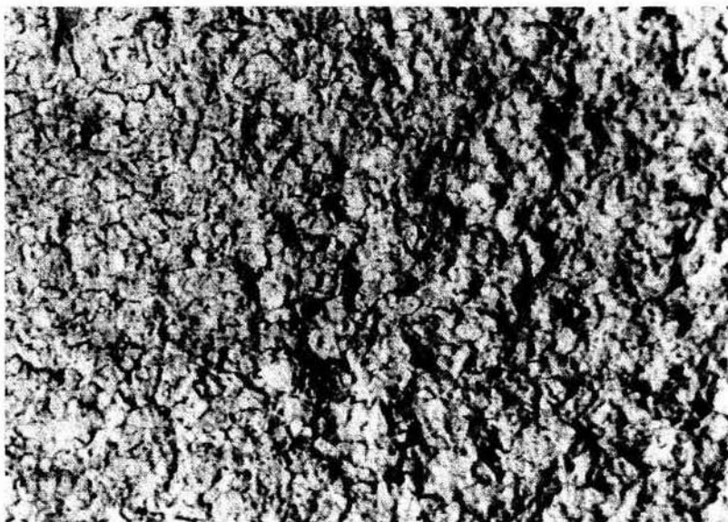
Figura 6.37. Fotografía tomada con microscopio óptico a una amplificación de 50x, de una muestra de Ti hidrogenado a 650°C, utilizando un proceso de metalografía para revelar los hidruros. Los hidruros de titanio se ven como cordilleras en la superficie de la muestra.
