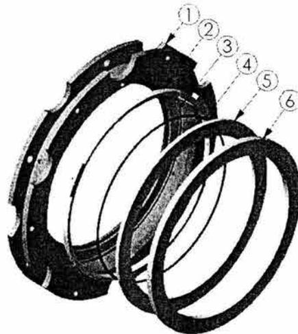
Figura 3.13. 1) Celda 2 de B2, 2)soporte radial, 3) lente, 4) O-ring y 5) y 6) separadores de S1
