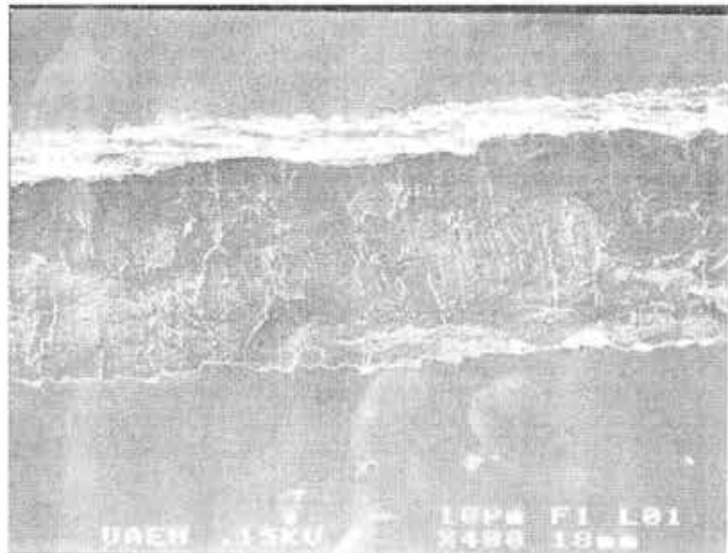
Fotomicrografía 25 – 400X En esta ampliación de la imagen anterior pueden distinguirse más claramente las superficies limpias y rectas de la falla del revestimiento, con bordes dentados atribuibles al mecanismo de tipo frágil; en el fondo, el sustrato de acero muestra indicios de deformación plástica.
